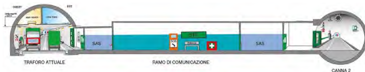
Figura 6 - Sezione Traforo del Frejus T4
